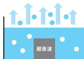
水を超音波で振動させて小さな粒子にし、霧状に噴出するタイプ。
