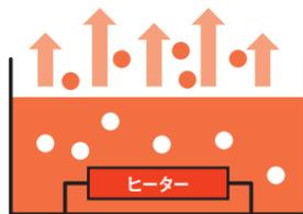
加湿器内に内蔵されたヒーターで水を加熱し、蒸気を生じさせて加湿する。
